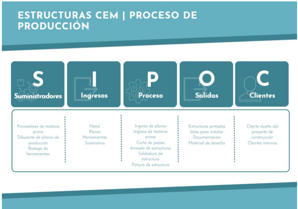
Figura 4.11: Sipoc Estructuras CEM
