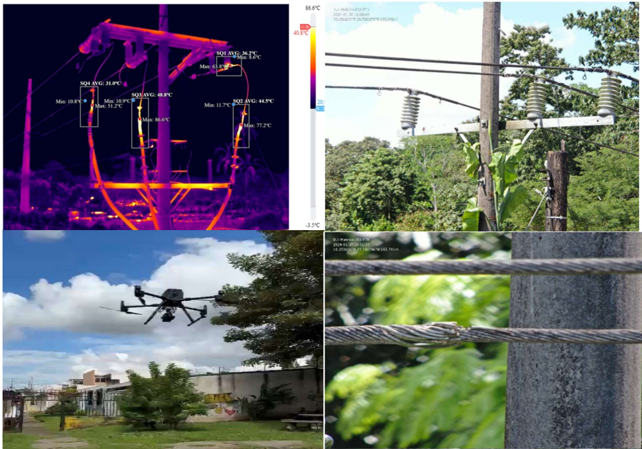
Figura 5.14 Evaluación y análisis con dron a las secciones que mayor DPIR aportan a los circuitos de la subregión de Limón-Talamanca
