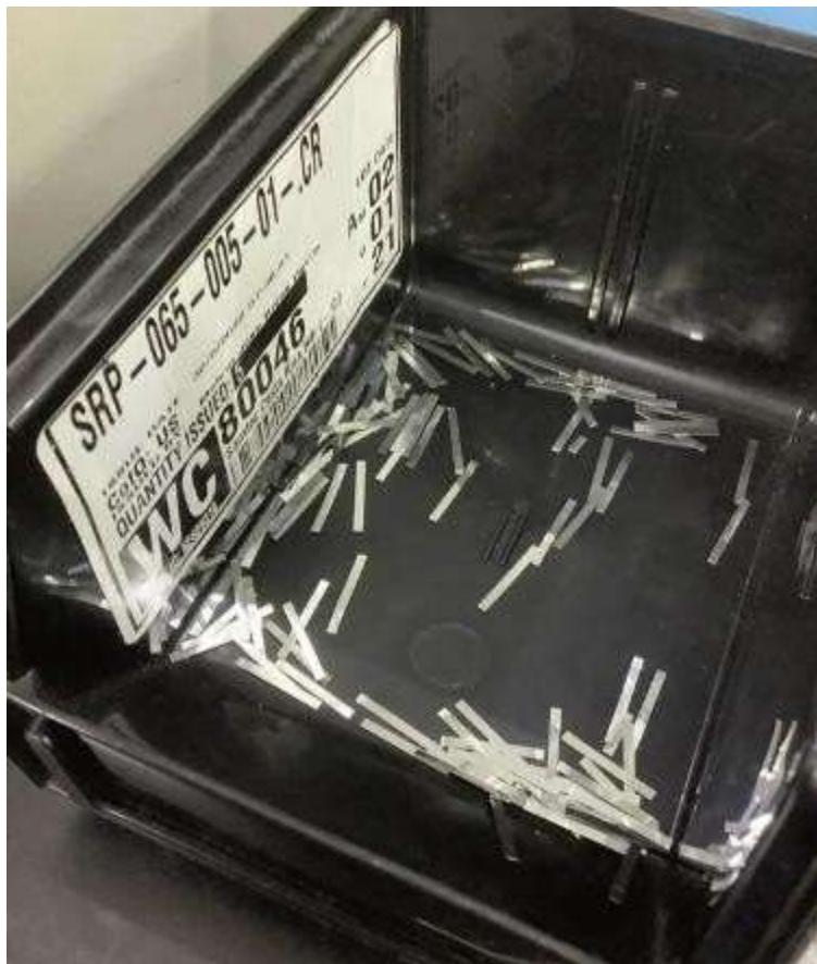
Figura 4.43: Banda de soldadura utilizada en el proceso de hot bar
