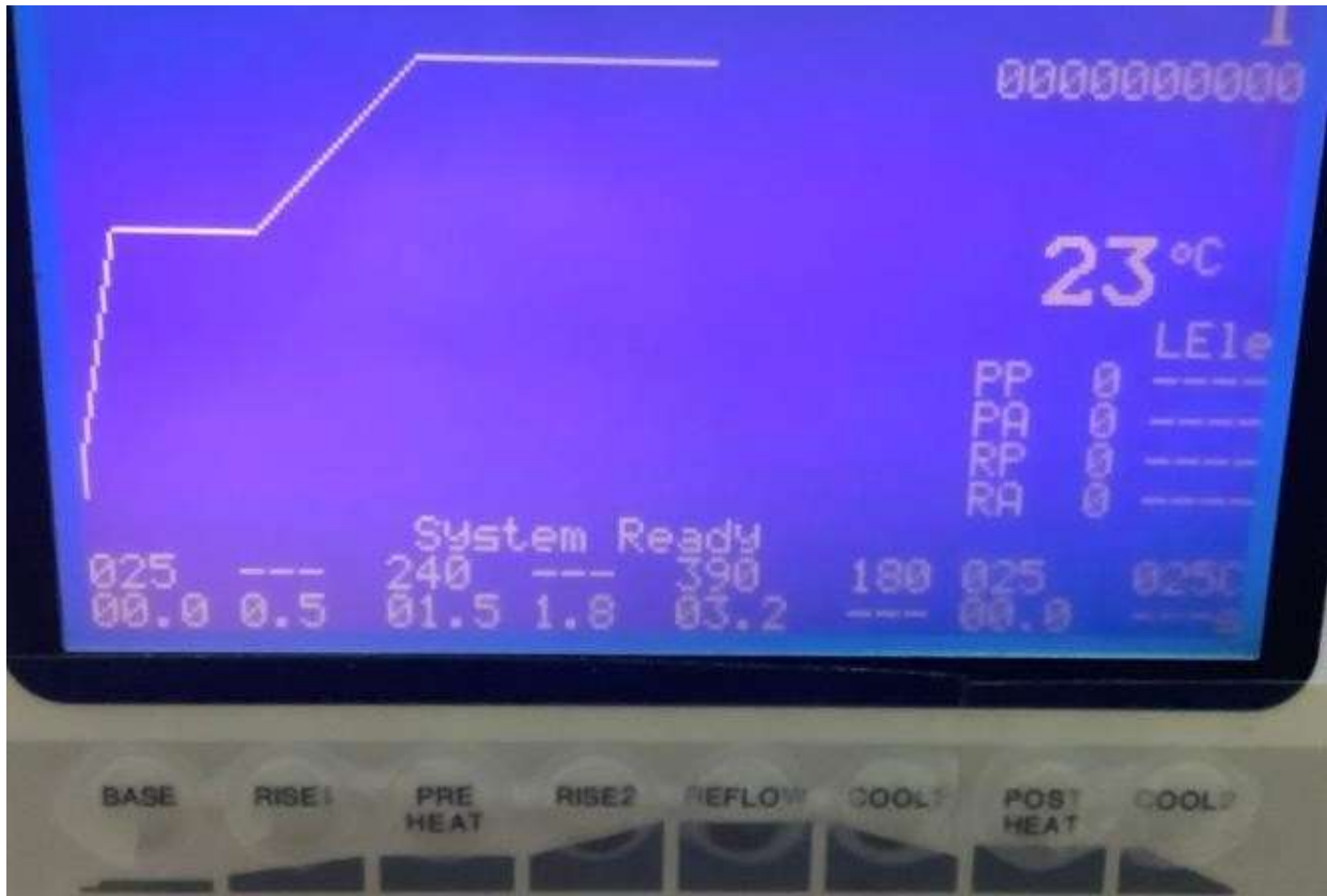
Figura 4.7: Parámetros de la hot bar #1
