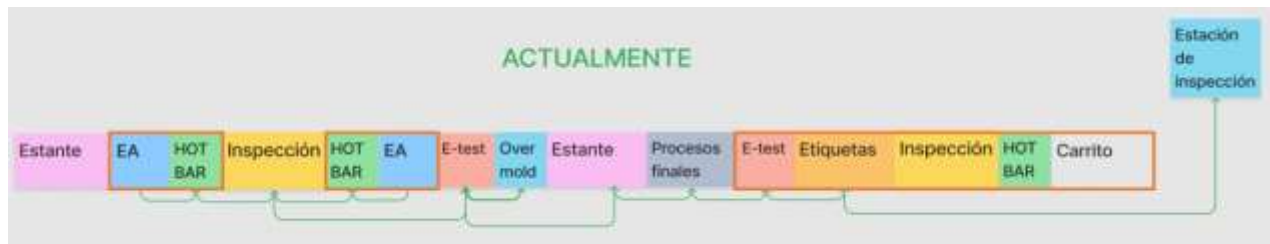
Figura 5.15: Distribución de la planta después de la implementación de la estación de alineamiento
