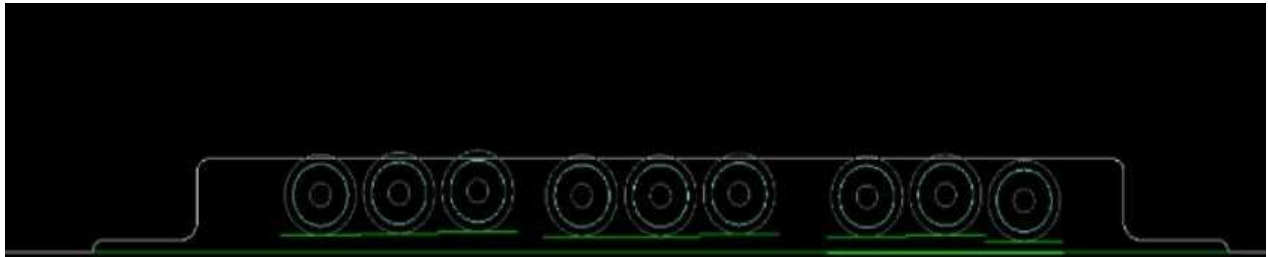
Figura 4.41: Vista frontal del thermode actual interactuando con el cable y la tarjeta
