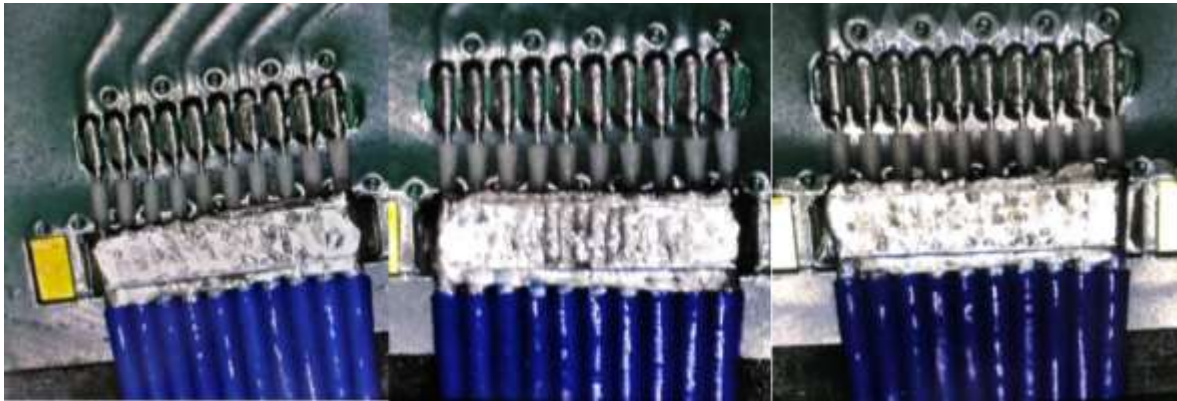
Figura 4.46: Prueba con thermode Cadence/perfil PICS/tarjeta con diferentes alturas de soldadura con banda
