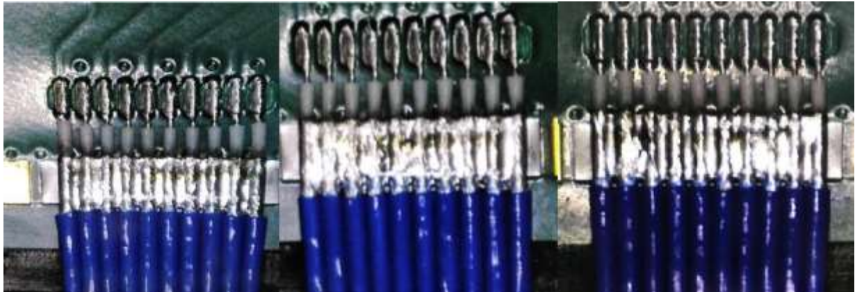
Figura 4.49: Prueba con thermode Cadence/perfil estándar/tarjeta con diferentes alturas de soldadura sin banda
