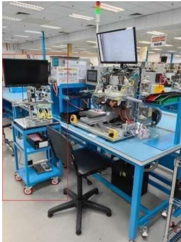
Figura 4.45: Estación de alineamiento implementada en el proceso de hot bar
