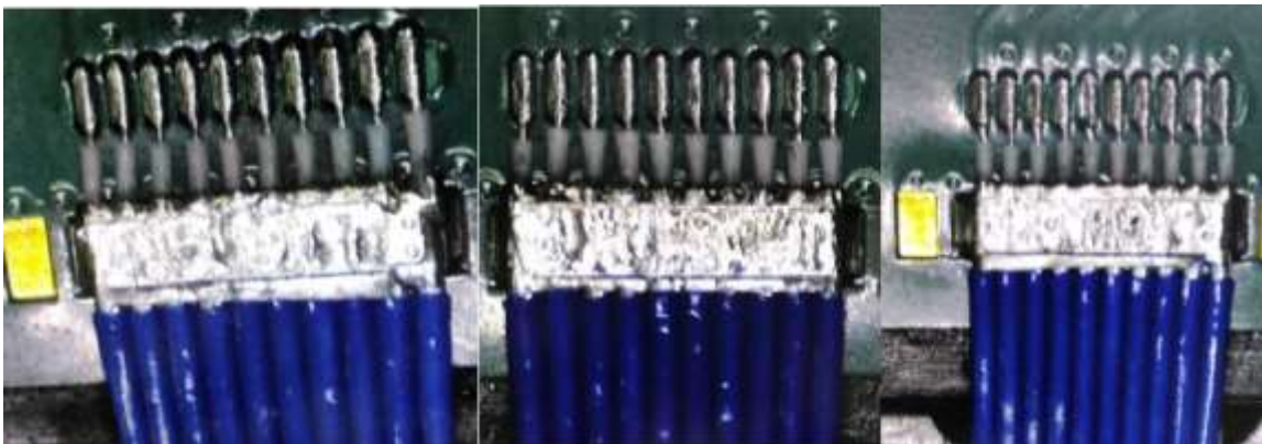
Figura 4.48: Prueba con thermode Cadence/perfil estándar/tarjeta con diferentes alturas de soldadura con banda
