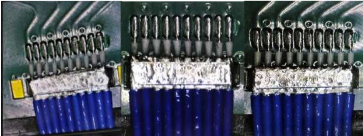
Figura 4.52: Prueba con thermode estándar/perfil estándar/tarjeta con diferentes alturas de soldadura con banda
