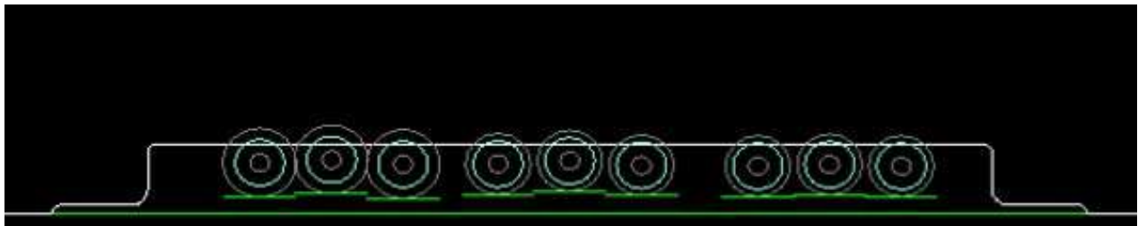
Figura 4.42: Vista frontal del thermode estándar con interacción en el cable y la tarjeta
