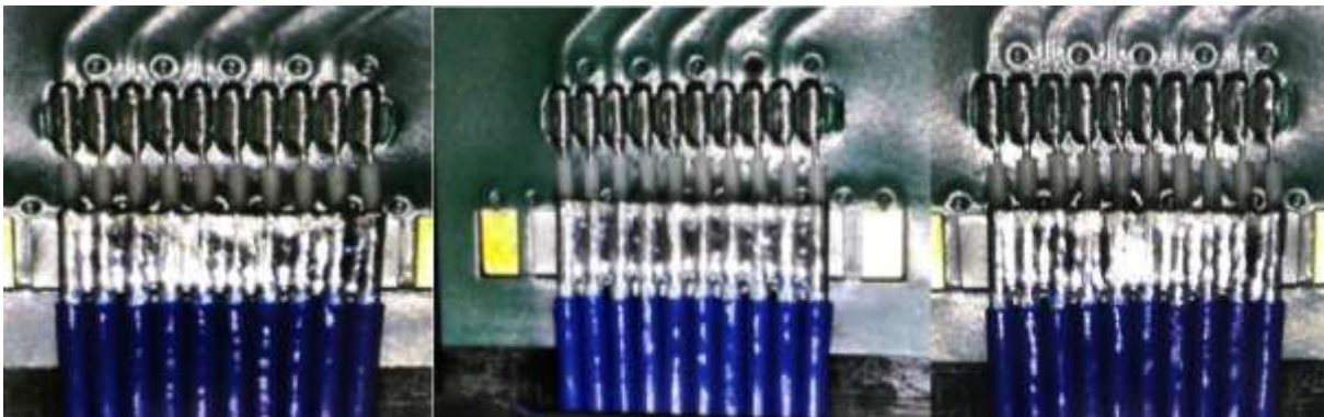
Figura 4.47: Prueba con thermode Cadence/perfil PICS/tarjeta con diferentes alturas de soldadura sin banda
