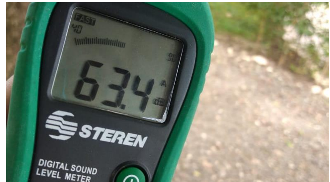
Fotografía 75. Medición de ruido: área trasera del lote.
