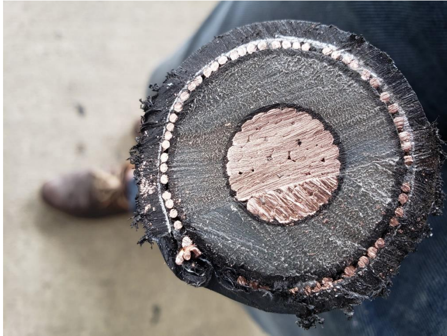
Figura 18. Cable de potencia 500 MCM 35 kV. Fuente: ICE
