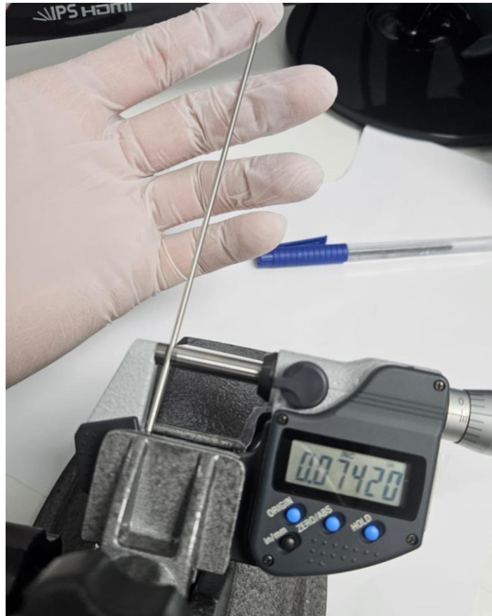
Figura 4.22: Ejecución de inspección del diámetro externo con un micrómetro digital
