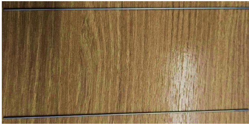
Figura 4.17: Mandriles seleccionados para ejecutar la validación de la inspección del diámetro externo con micrómetros digitales.
