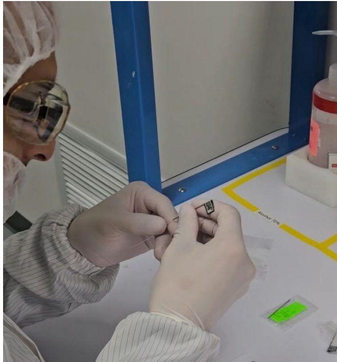
Figura 4.18: Ejecución de inspección del diámetro interno con pines clase Z
