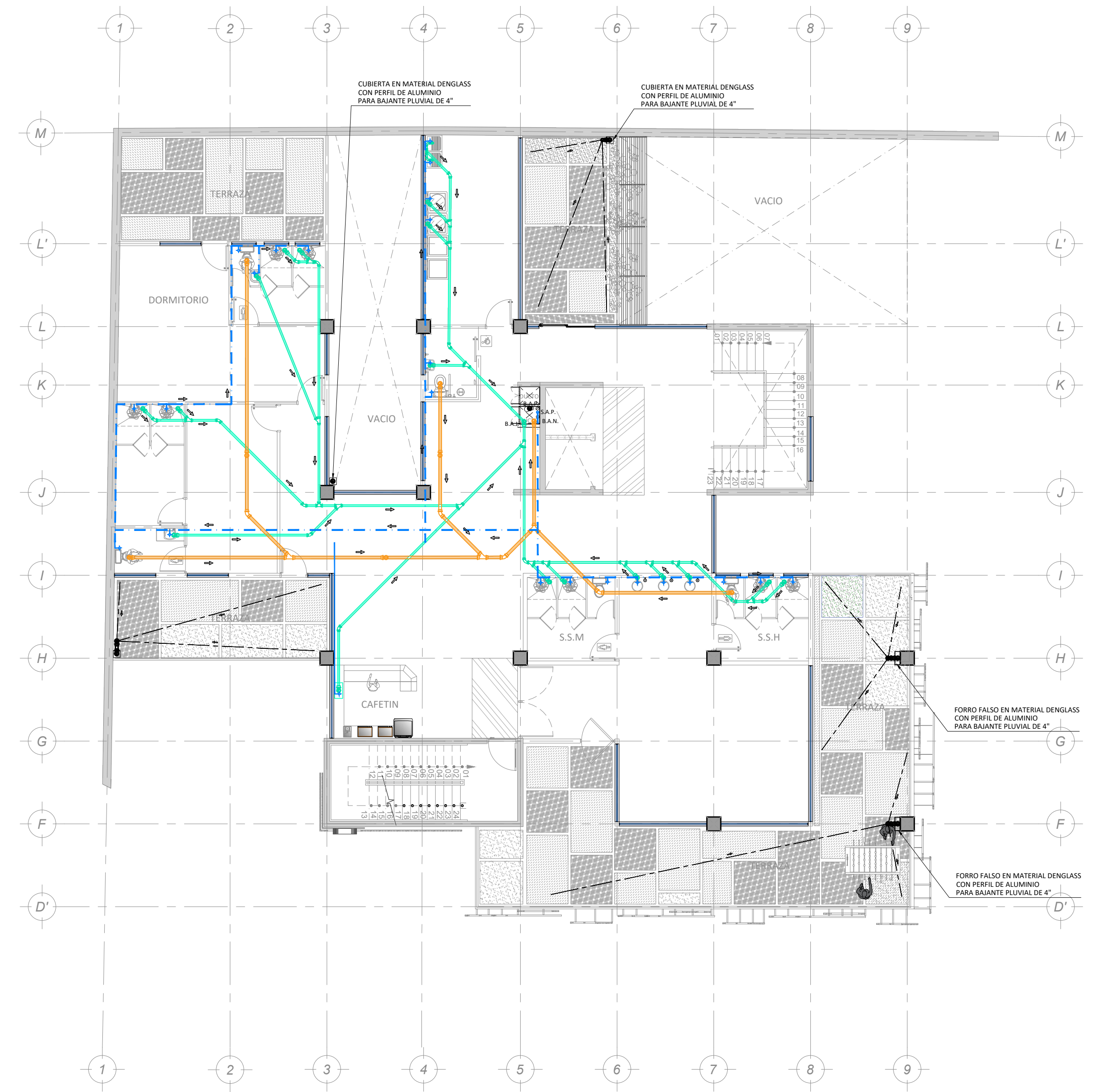
PLANTA DE DISTRIBUCIÓN MECANICA EN NIVEL 4 ESCALA 1:125
