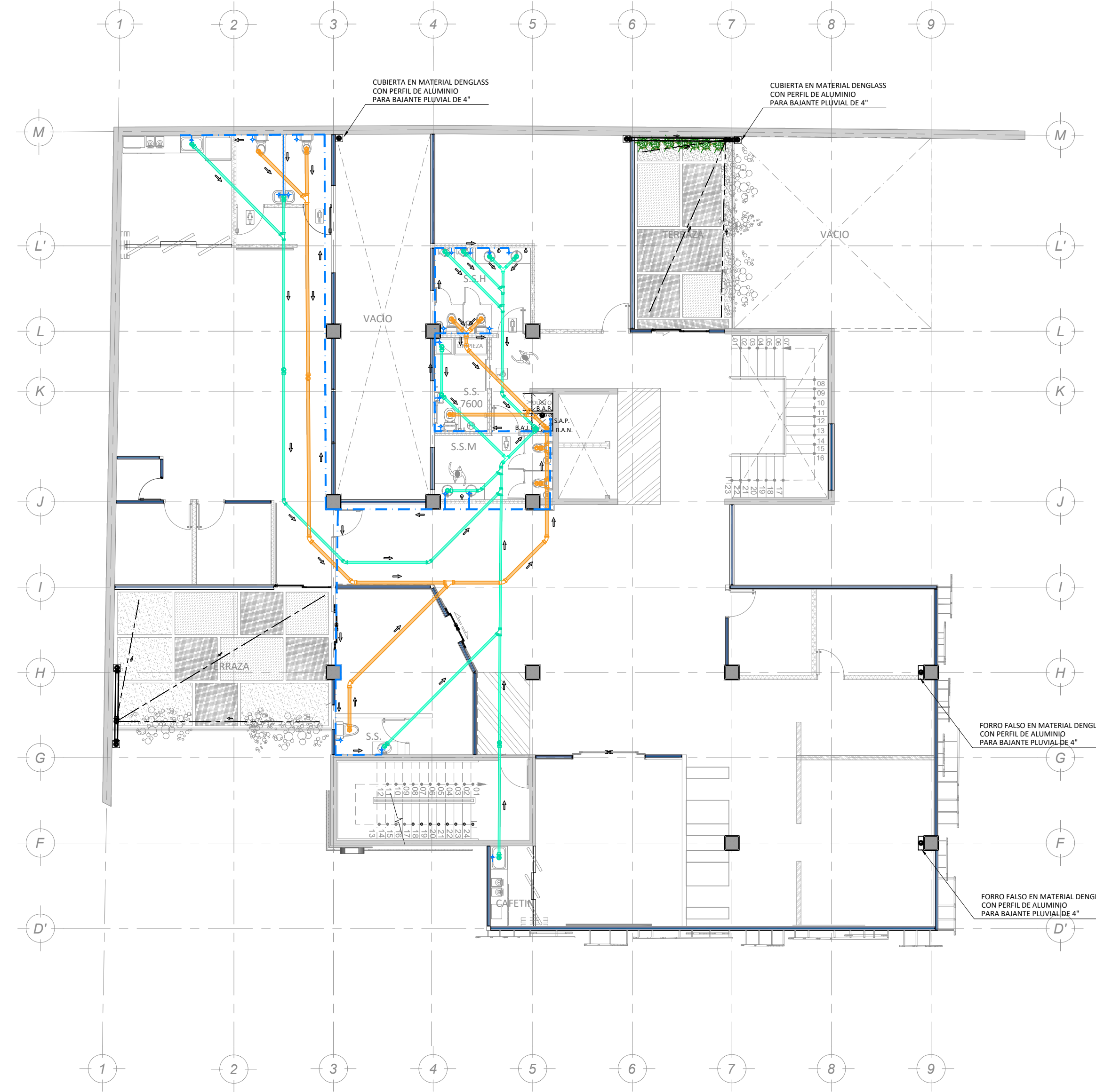
PLANTA DE DISTRIBUCIÓN MECANICA EN NIVEL 3 ESCALA 1:125
