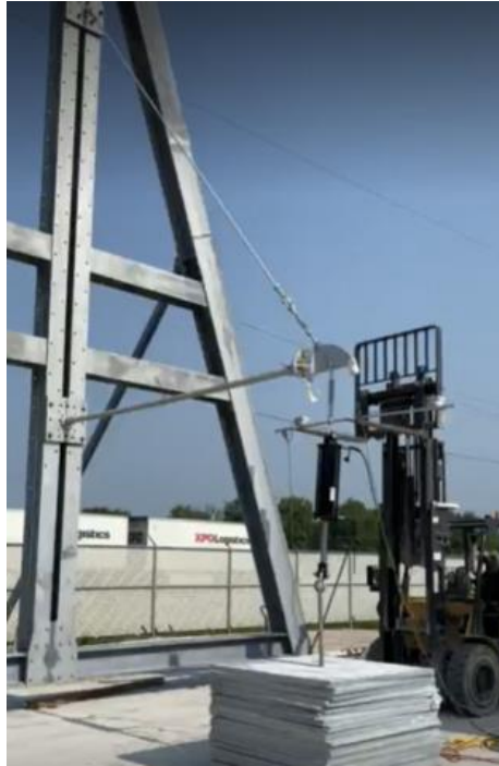
Figura 33: Configuración de prueba con método de punto fijo
