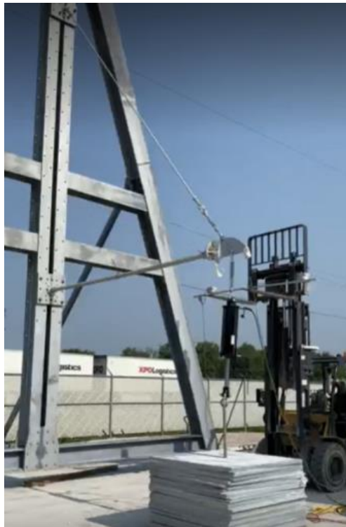
Figura 31: Configuración de prueba con método de peso libre
