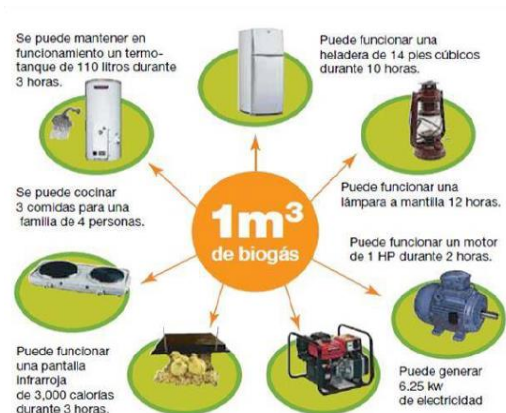
Ilustración 10: Aplicaciones por 1 m 3 de biogás
