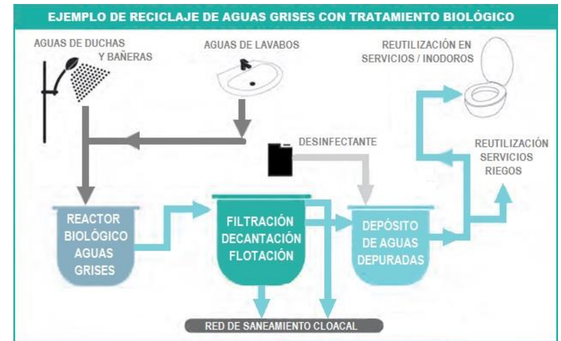
Figura 9. Ejemplo de reciclaje de aguas grises
