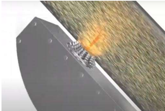
Figura 5.2: Medición del NIR en la línea de producción
