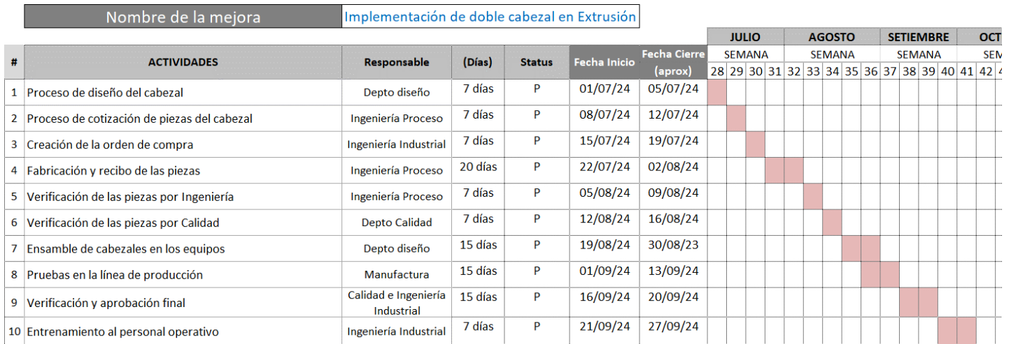
Figura 5.7: Diagrama de Gantt del tiempo requerido para la implementación de los cabezales
