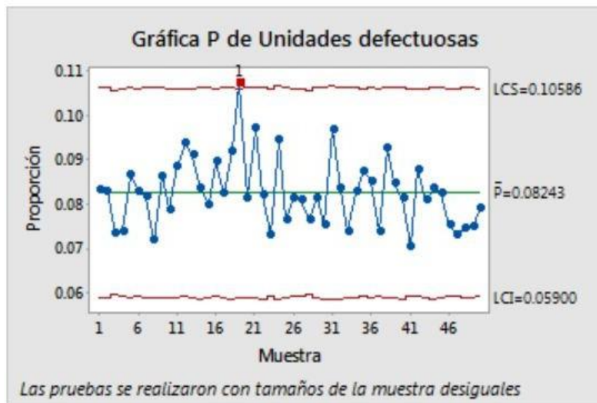
Figura 2.16: Ejemplo de un gráfico de control por atributos
