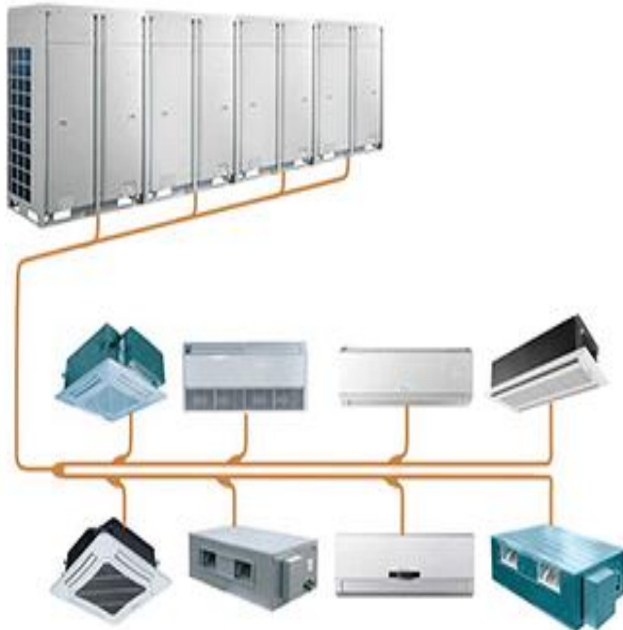
Sistema de Flujo o Volumen Variable de Refrigerante
