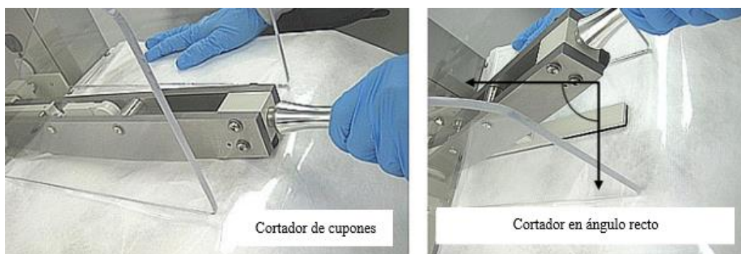
Figura 4.35 Herramienta de corte de cupones en el pouch.
