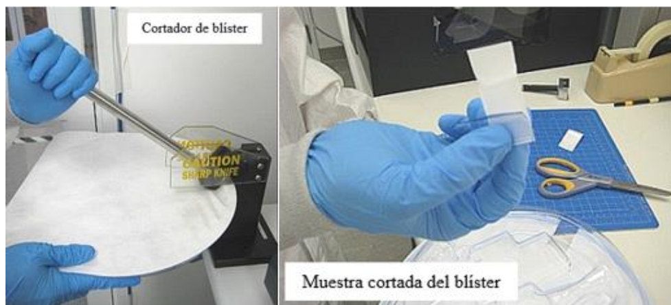
Figura 4.34 Herramienta de corte de cupones y cupón extraído del blíster.
