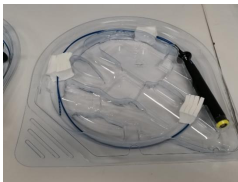
Figura 4.4 Catéter ensamblado en Blíster.
