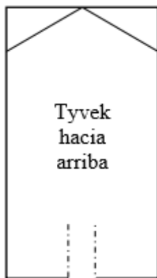
Figura 4.33 Localización de los cortes para cupones del pouch sellado.
