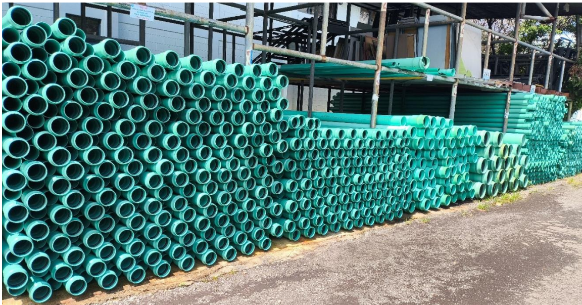
Figura 4.16: Almacenamiento de Tubería en Racks
