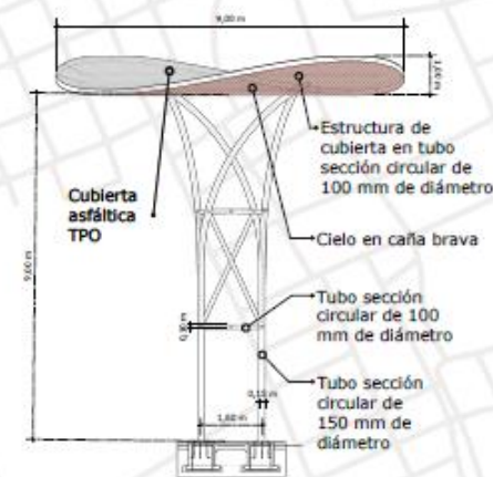
DETALLE ESTRUCTURA MENOR PLAZOLETA Escala 1:50
