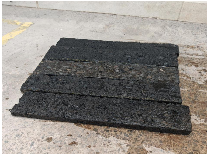
Fig. 21. Vigas de asfalto.
