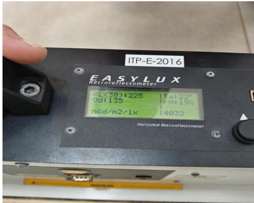
Fig. 40. Medición de Retrorreflectómetro Pintura Blanca. Fuente: Propia
