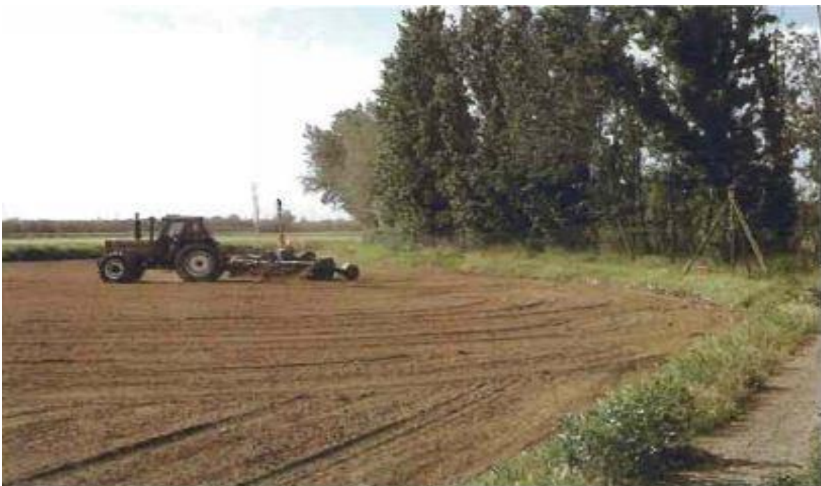
Fig. 30.- Equipo de nivelación guiado por rayo láser en plena tarea de trabajo.
