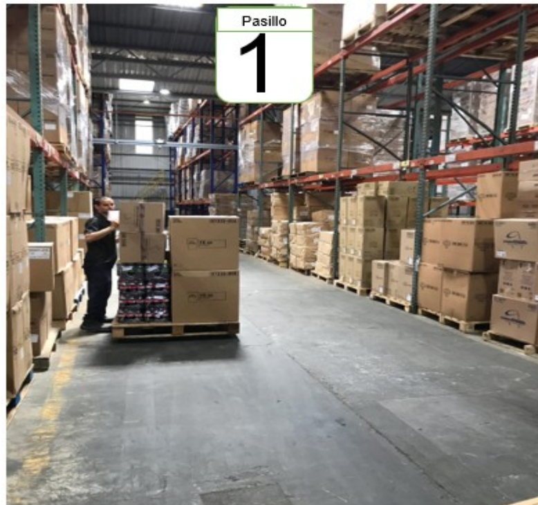
Ilustración 25: Rotulación de pasillos
