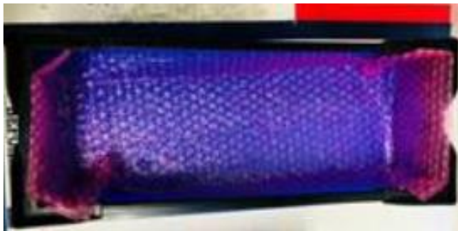
Figura 2.1.1: Bins azules con lámina doble burbuja (3/16" x 6" x 24")
