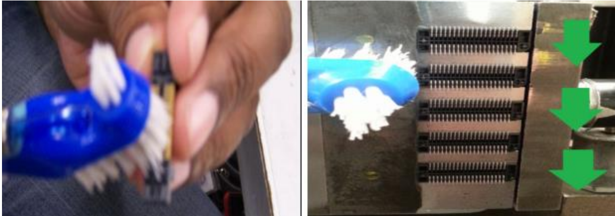
Figura 4.40: Limpieza de conectores
