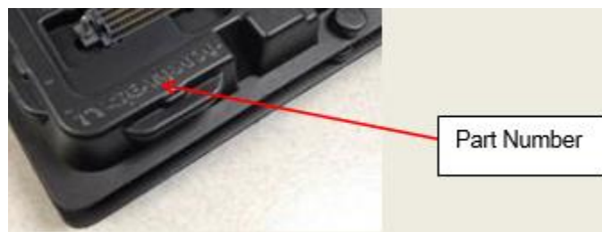
Figura 2.2.2: Verificación del part number en tray
