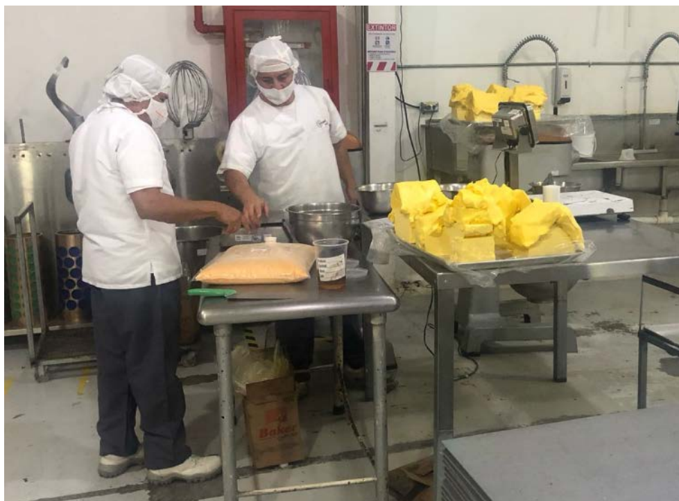
Figura 4.7. Proceso de pesado de las materias primas en elaboración
