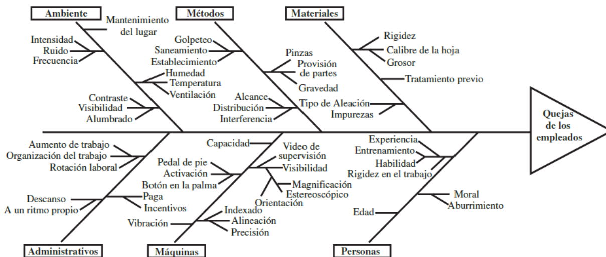
Figura 2.19. Ejemplo de un diagrama de causa y efecto
