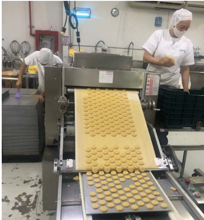
Figura 4.8. Proceso de moldeado de galletas en elaboración
