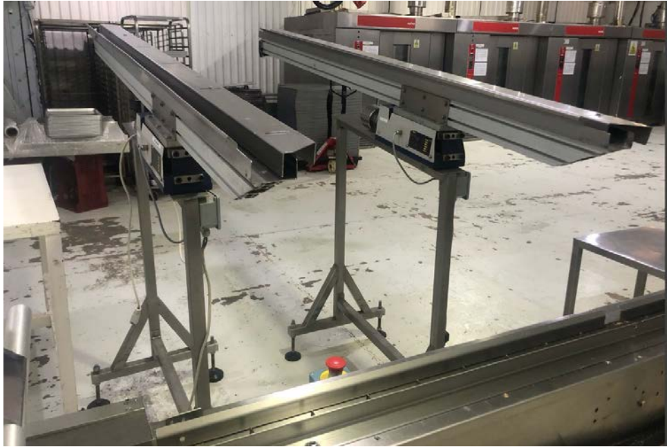
Figura 5.12. Cargadores de galletas en desuso
