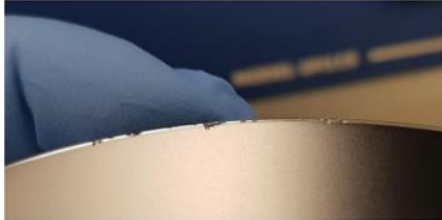
Figura 28A: daño en borde wafer
