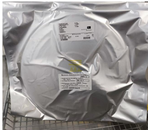
Figura 4.27: Carrucha en el empackado al vacío
