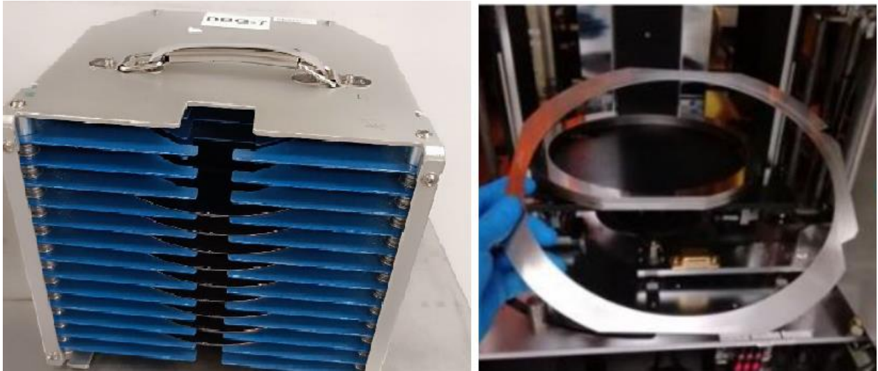
Figura 4.11: Obleas y aros metálicos separados luego de Aplicado de Resina
