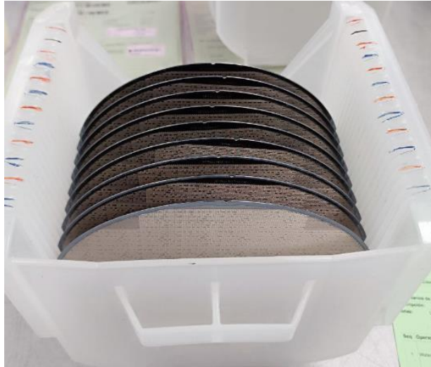
Figura 2.19: Oblea antes de ser procesada
