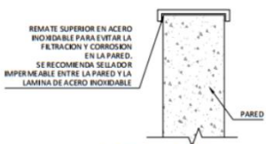
DETALLE DE TERMINACION DE PARED SIN ESCALA
