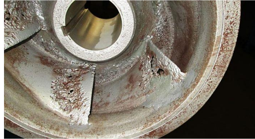
Ilustración 51: Corrosión por cavitación.
