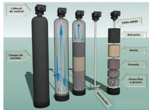
Figura 7. Diagrama filtro multimedia (Fernández, 2023, p.21).
