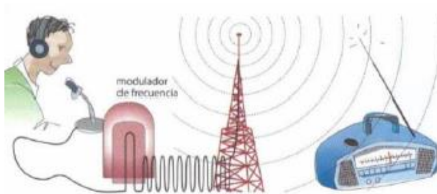
Ilustración 12. Dispositivo para comunicación modo simplex
