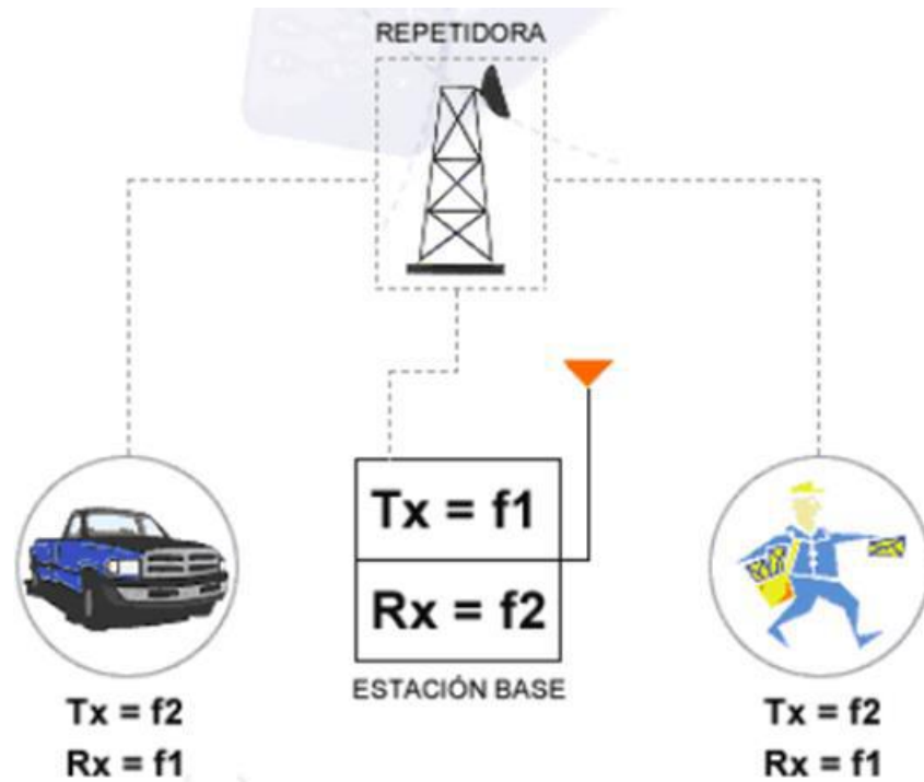
Ilustración 14. Sistema de radiocomunicaciones modo dúplex
