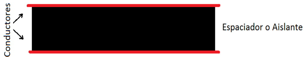
Ilustración 27. Línea de transmisión balanceada.
