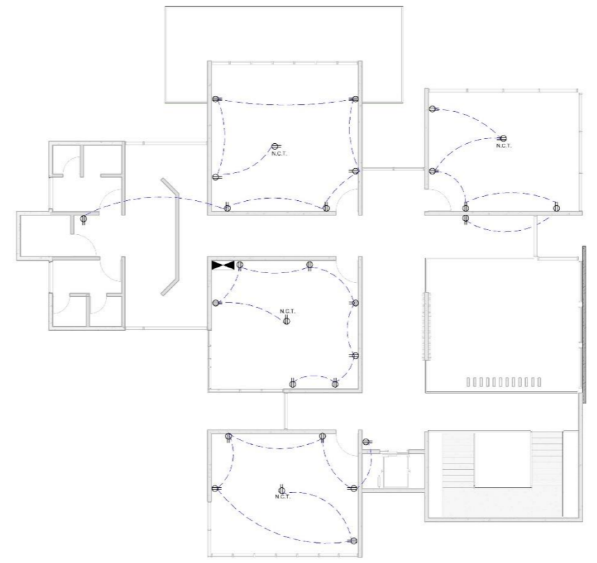
PLANTA TOMACORRIENTES N. +3.50m 1:100
