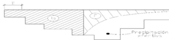
Figura 27. Generación de la precipitación efectiva
