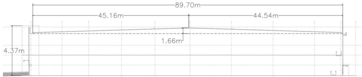
Figura 4.36 Vista en corte de la nave industrial, subida y tendido
