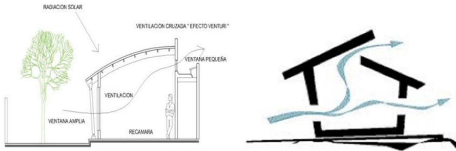
Figura 2.15: Diagrama básico de ventilación cruzada
