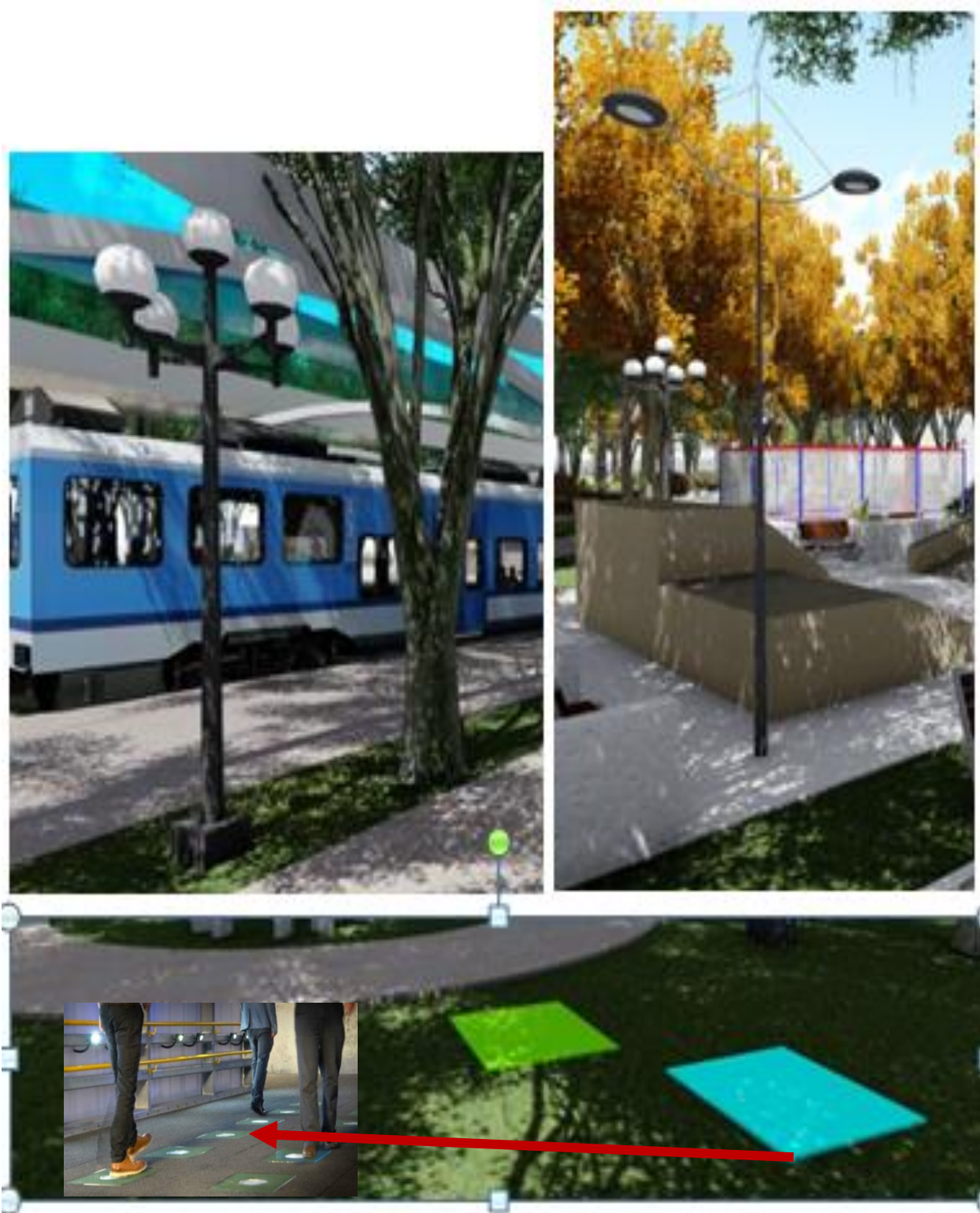
Figura 146. Luminarias colocadas en la propuesta, verticales y a nivel de piso (piezoelectricidad). Fuente: elaboración propia
