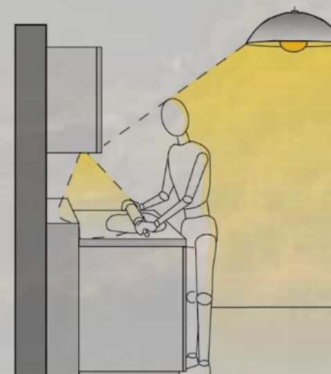
Figura 2.40 Iluminación en áreas de trabajo
