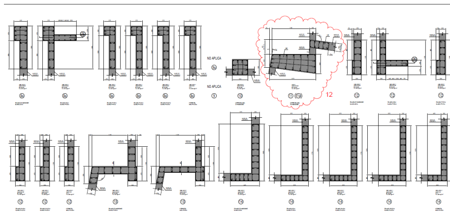
Figura 42. Ejemplo de columnas irregulares. Fuente: Volio & Trejos
