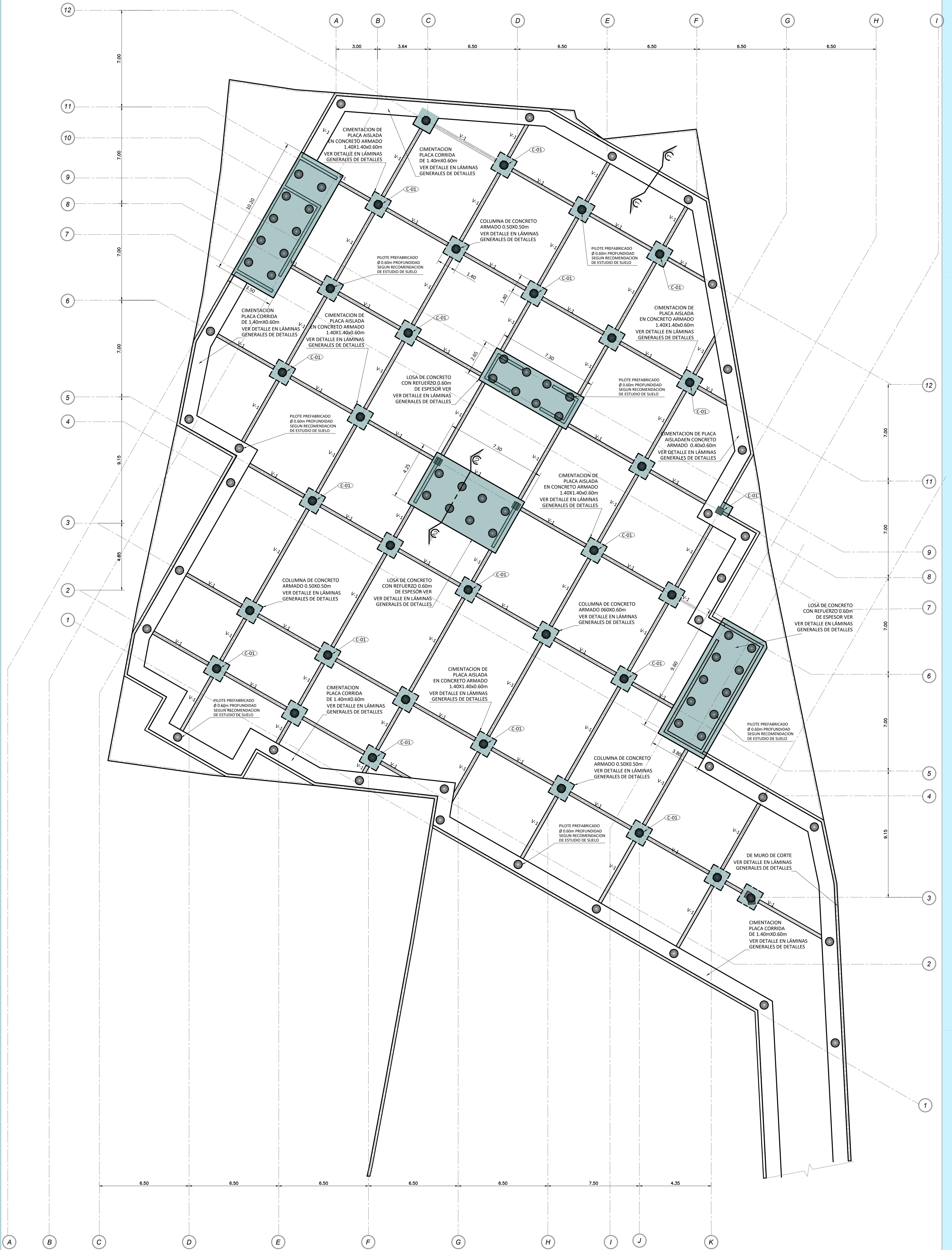
PLANTA ESTRUCTURAL DE CIMENTACION PROFUNDA, NIVEL SOTANO
