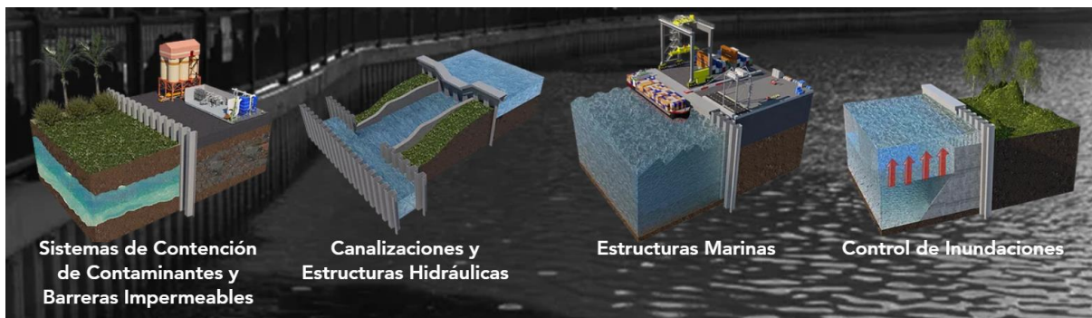
Ilustración 12. Usos tablestaca de PVC (Green Walls, 2018).
