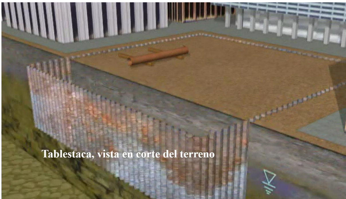
Ilustración 6. Tablestaca instalada en el perímetro de la construcción (Steel, 2012).
