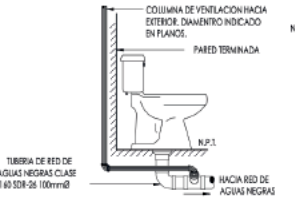
DETALLE TIPICO DE CONEXION DE VENTILACION PARA TUBERIAS DE AGUAS NEGRAS EN INODOROS SIN ESCALA
